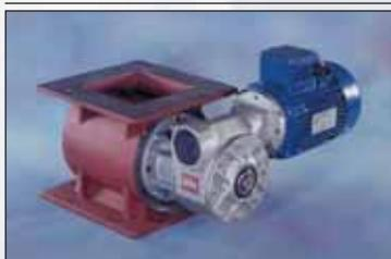
**VALVOLA STELLARE (a richiesta):** per lo scarico in continuo dalle trameggi, con potenzialità e materiali diversi a seconda del carico materiale e della natura delle polveri da scaricare.
