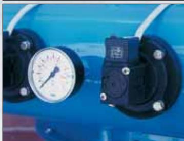
**ELETROVALVOLA A MEMBRANA:** valvole a due vie normalmente chiuse azionate da solenoide eccitato elettricamente; per aria compressa fino a 7 bar. Pressione nel serbatoio aria compressa: 4/7 bar.
